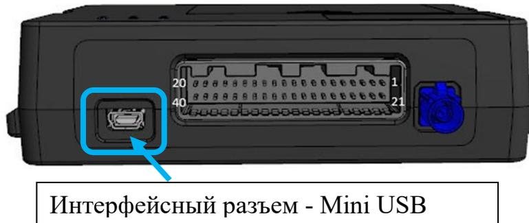
Рисунок 10 – интерфейсный разъем mini USB Блока УВЭОС
